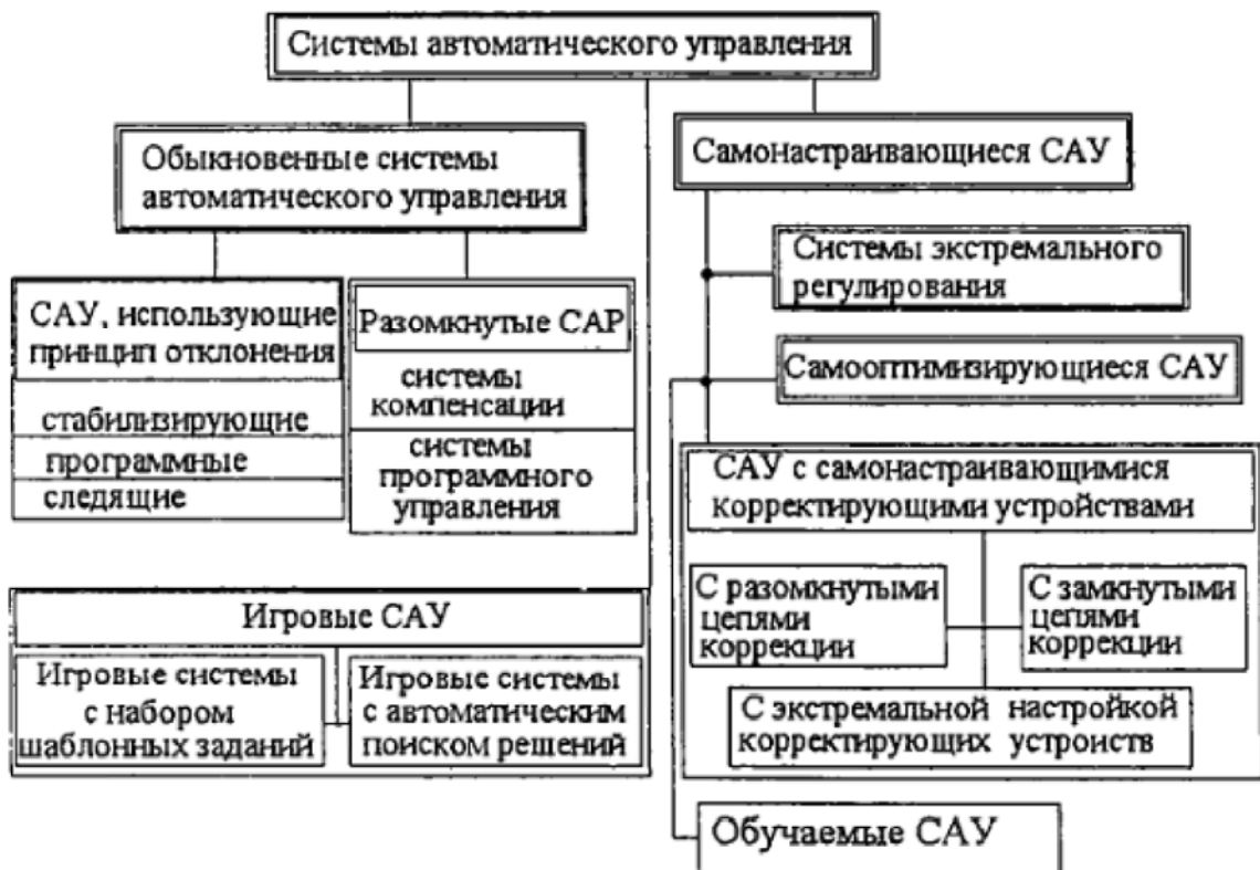
Рис. 4.1. Классификация систем автоматического управления
