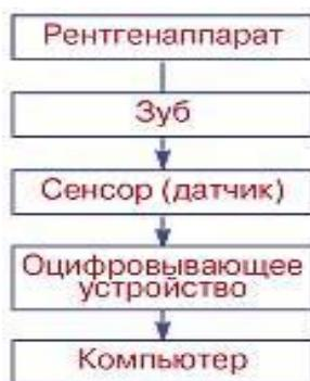
Рисунок 1 – Схема преобразования невидимого рентгеновского излучения в видимый свет
