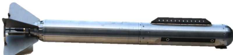
Рисунок 8 – Буксируемая гидроакустическая система
