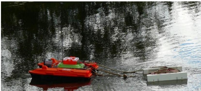
Рисунок 2 – Катер в снаряженном состоянии на воде буксирующий антенну профилографа
