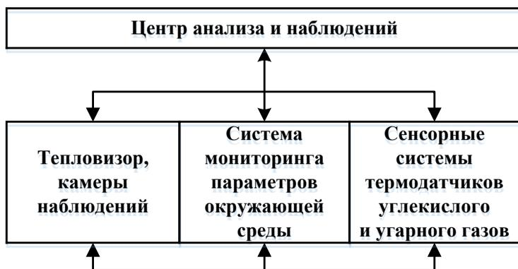
Рисунок 1 – Блок-схема взаимодействия систем мониторинга пожарной ситуации
